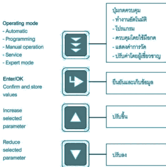
รูปที่ 1 แสดงอุปกรณ์ควบคุมด้านหน้ามีปุ่มกดควบคุม
