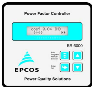
รูปที่ 1 แสดงอุปกรณ์ควบคุมด้านหน้า มีปุ่มกดควบคุมทั้งหมด 4 ปุ่ม
